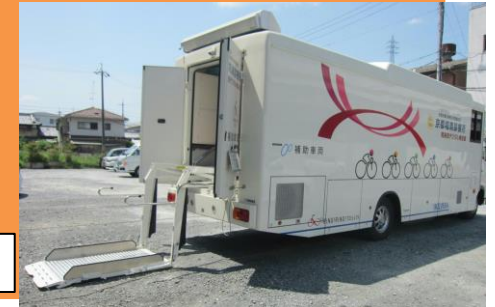
車いす昇降用リフト
